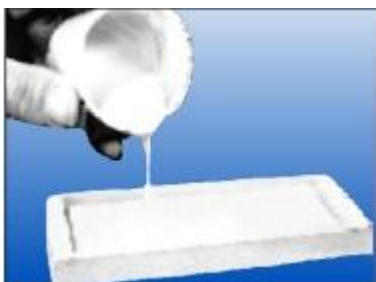
Coulée du ciment
